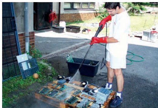
Veškeré komponenty bylo třeba nejprve očistit proudem vody.
